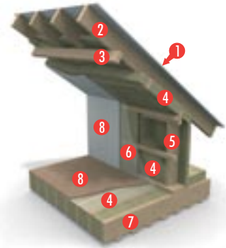
УТЕПЛЕНИЕ МАНСАРДЫ. 1 - кровельное покрытие, 2 - стропильная нога, 3 - обрешетка, 4 - PAROC UNS 37, 5 - деревянный каркас, 6 - пароизоляция, 7 - балка перекрытия, 8 - отделка.
